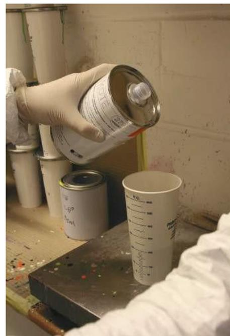
Смешивание также может производиться по объему в измерительном сосуде с мерными делениями, или шприцем. Крайне важно соблюдать пропорцию смешивания краски с отвердителем, так как она влияет на время высыхания, адгезию, степень глянца, эластичности и срока службы покрытия. Пожалуйста, обратитесь к Технической спецификации № 1751 для ознакомления с пропорциями смешивания.
