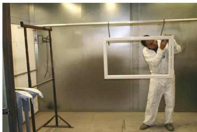
При размещении больших изделий горизонтально на козлах, необходимо оставлять значительное место до стен камеры для прохода, чтобы иметь доступ к изделию со всех сторон, а так же к центру изделия.
