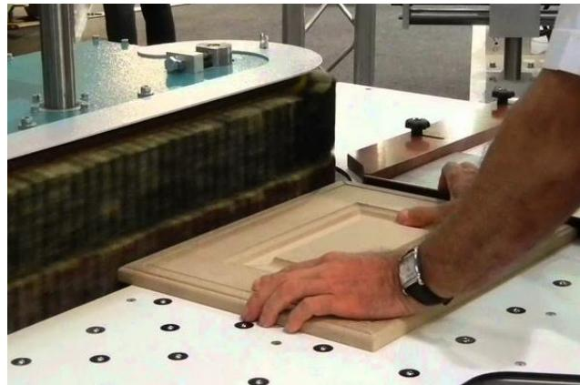
После ручной шлифовки и после шлифовки автоматом, в котором отсутствует финишный обдув изделий, поверхность МФД фасада необходимо обдуть сжатым воздухом для полной очистки ее от пыли и остатков шлифовального материала.
