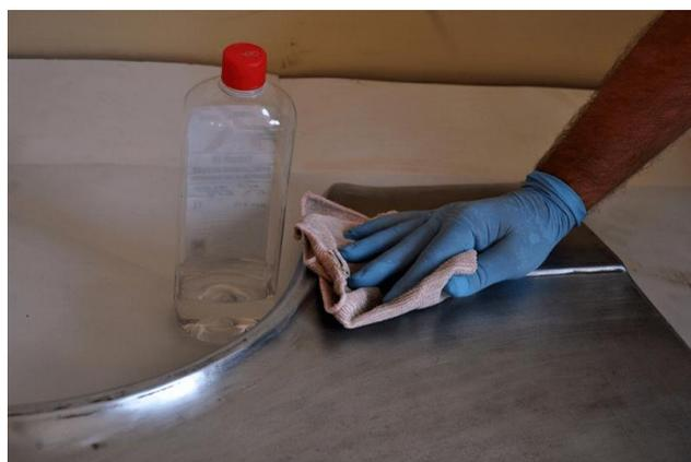
При подготовке металла по типу Sa3, то есть с использованием пескоструйной обработки, обезжиривание не требуется, если окраска производится сразу же после обработки в течении 1-2 дней и в этот период конструкция не находилась в условиях повышенной влажности или под дождем, но при проведении обезжиривания спецсоставами качество и долговечность покрытия будут выше.
