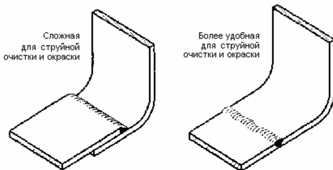
Фигура D.2 – Конструкция сварных швов
