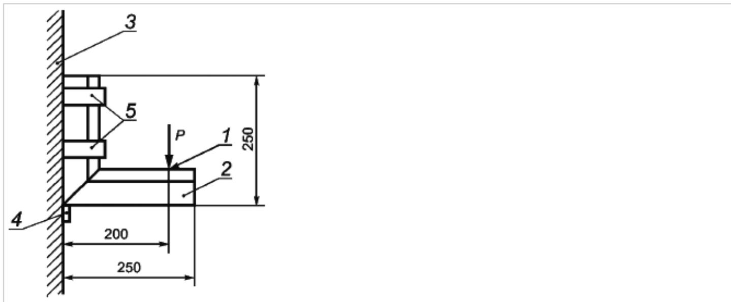
1 - точка приложения нагрузки ; 2 - испытательный образец ; 3 - вертикальная опора ; 4 - упор ; 5 - хомуты для крепления образца ; P - поперечная нагрузка, действующая на угловое соединение
