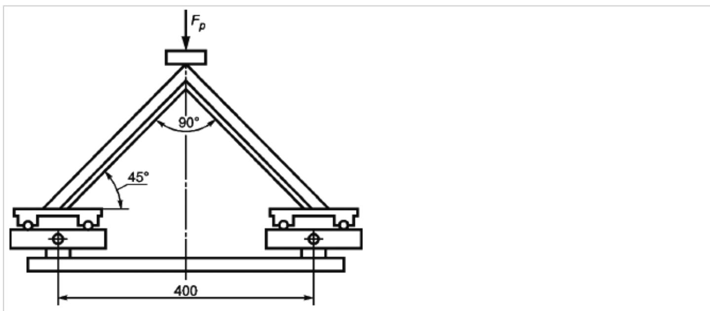
$F_p$  - вертикальная сжимающая нагрузка на угловое соединение
