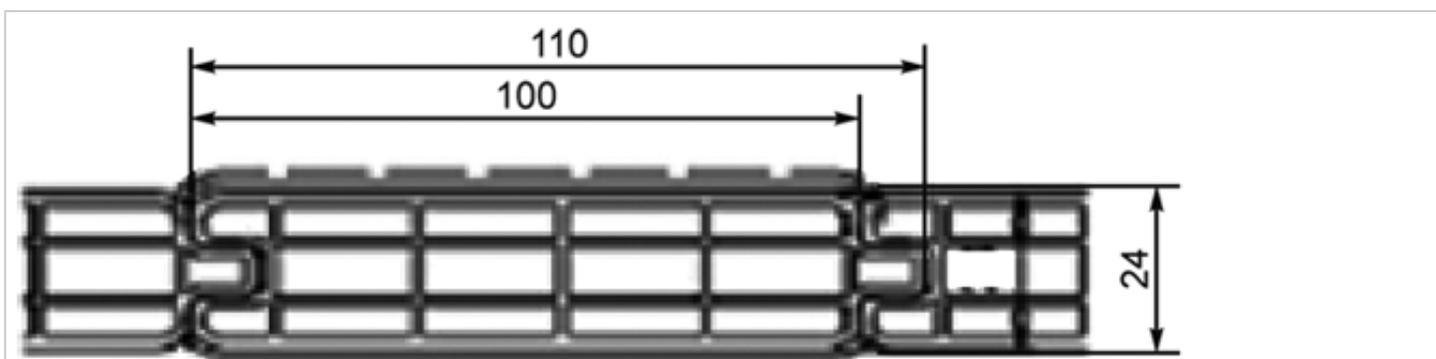
Рисунок 7 - Пример многокамерного профиля ПВХ для изготовления филенок
