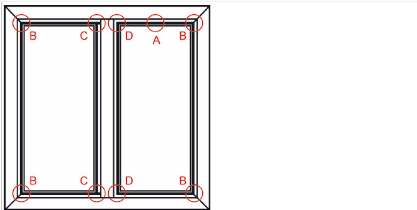
Рисунок Г.1 - Схемы установки уплотняющих прокладок в створке и раме с импостом оконного блока из профилей ПВХ
