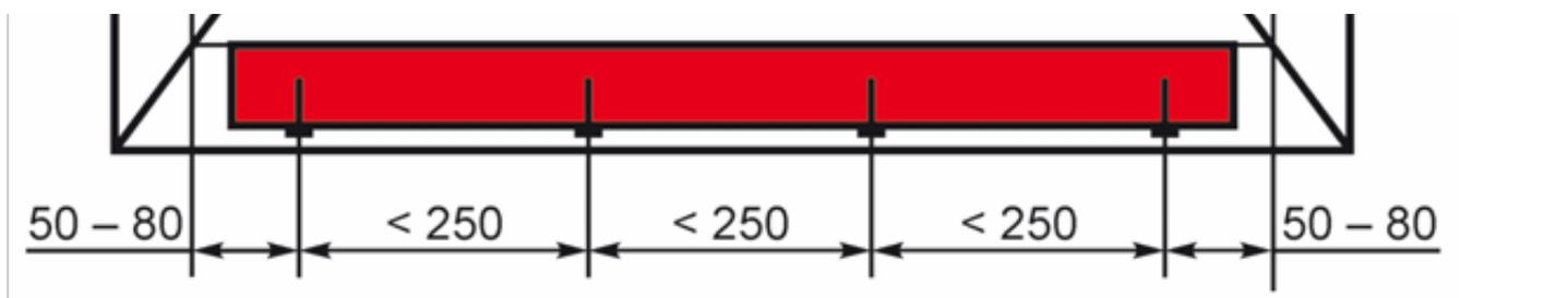
б) Схема крепления усилительных вкладышей в цветных профилях ПВХ
