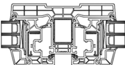
г) Импостный притвор с двумя открывающимися створками для оконных блоков со
