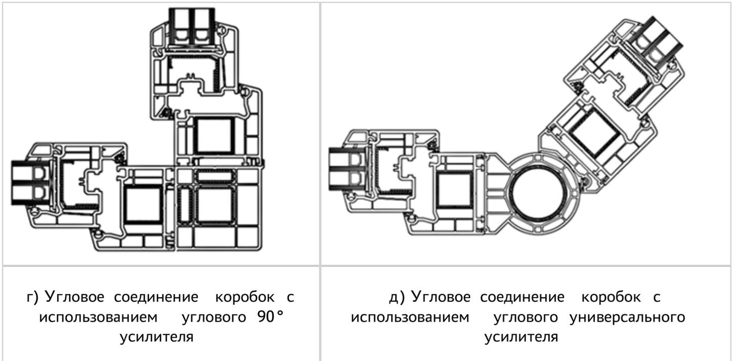
Рисунок 3 - Примеры угловых и торцевых соединений оконных и балконных блоков
