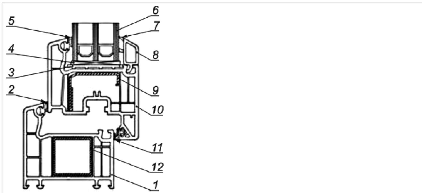
1 - коробка ; 2 - прокладка наружного уплотнения ; 3 - базовая подкладка ; 4 - опорная подкладка ; 5 - наружная уплотняющая прокладка стеклопакета ; 6 - стеклопакет ; 7 - внутренняя уплотняющая прокладка стеклопакета ; 8 - штапик ; 9 - усилительный вкладыш створки ; 10 - створка ; 11 - прокладка внутреннего уплотнения ; 12 - усилительный вкладыш коробки
