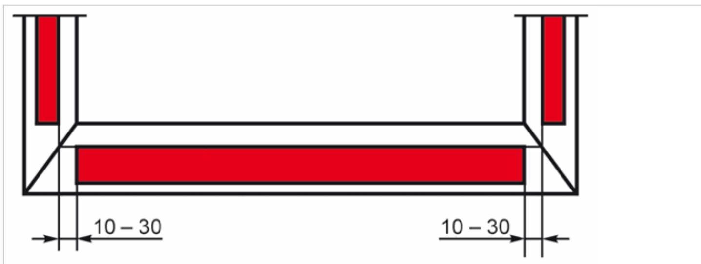
Рисунок 9 - Пример установки усилительных вкладышей в профилях ПВХ
