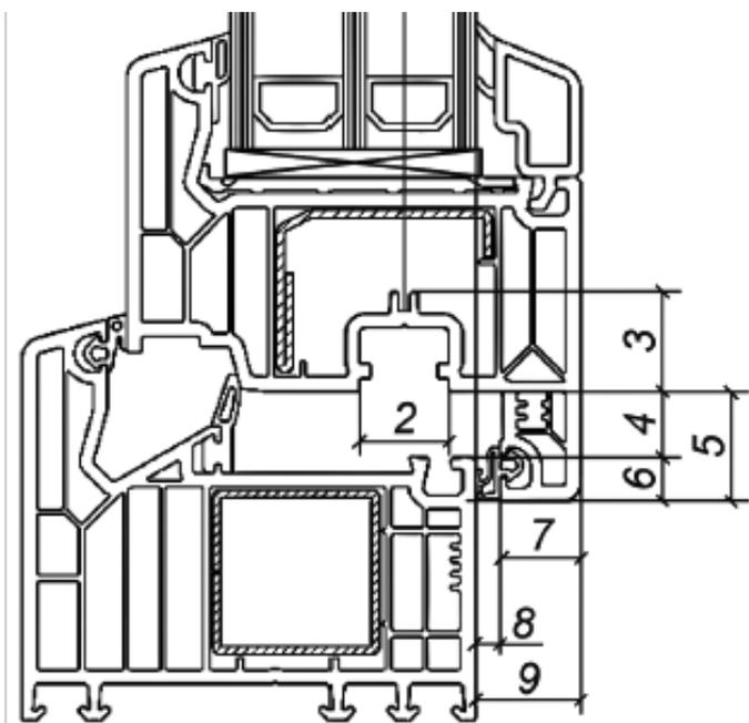
1 - ось фурнитурного паза ; 2 - паз для установки запирающих изделий ; 3 - глубина установки ручки ; 4 - зазор в притворе ( фальцлюфт ) ; 5 - наплав створки ; 6 - размер притвора под наплавом ; 7 - толщина наплава ; 8 - зазор под наплавом ; 9 - высота притвора ( нахлеста )
