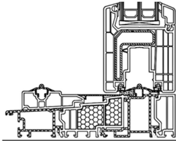
л) Балконное остекление из многокамерных профилей с подъемно-раздвижными створками
